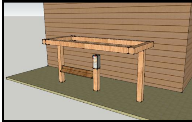
5. Instalación de costillas de sustentación.
